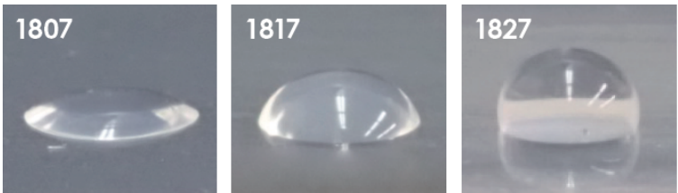
水接触角测试 (2 \mu L、1秒后)
