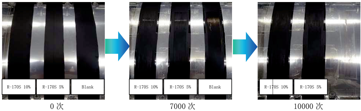
(Blank 经 7000 次的摩擦后材料出现破损)
